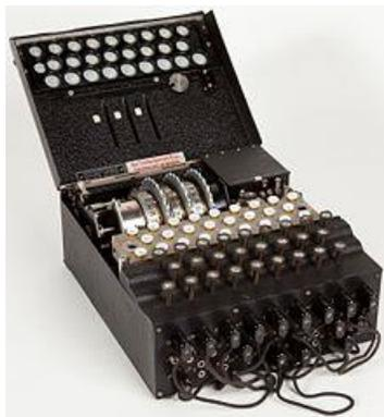
Cette machine électromécanique qui ressemble à une machine à écrire est à la croisée des méthodes anciennes et modernes de la cryptographie. Utilisée par les allemands pendant la seconde guerre mondiale, elle est constituée d'une partie mécanique utilisant des rotors et d'une partie construite autour de composants électriques permettant d'afficher le résultat du chiffrement.
